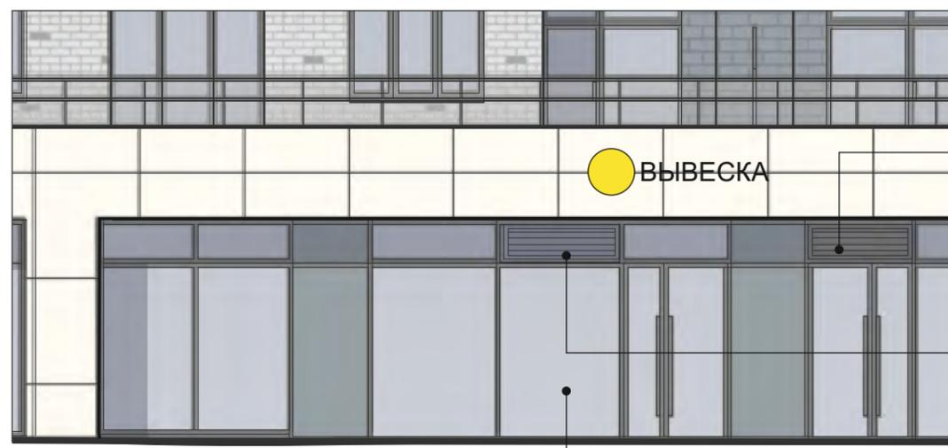
Вентиляционная решетка при установке блока в тамбуре RAL 7024
